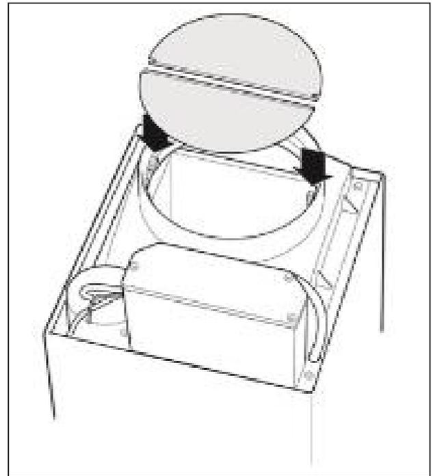
**7) Встановіть коробки повітропроводу і зафіксуйте їх гвинтами з монтажного комплекту.**
